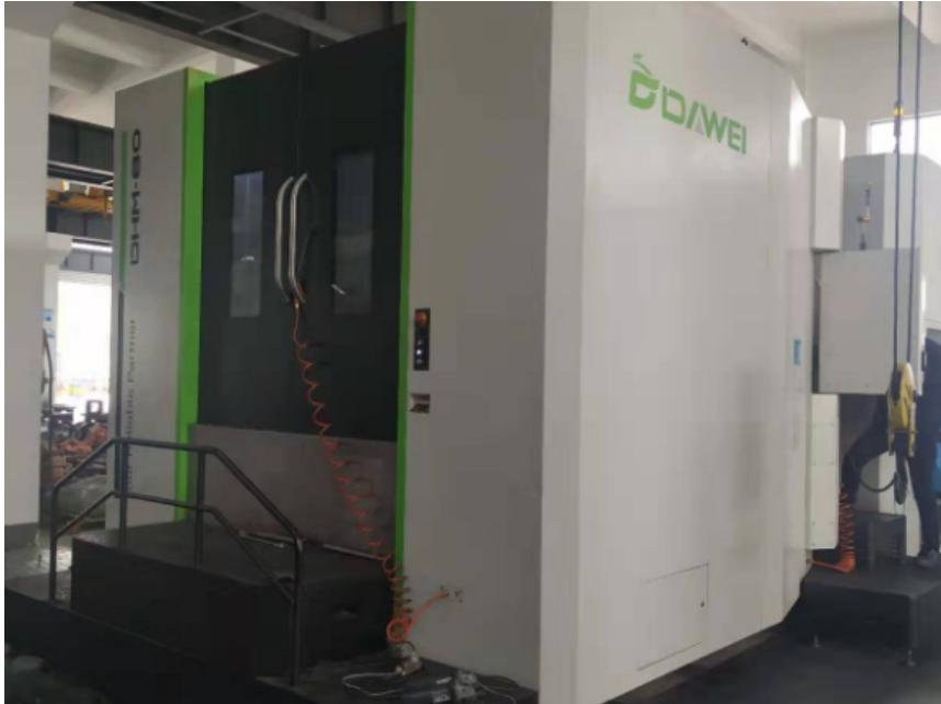
数控机床的常规保养得当与否，将直接影响加工中心的精度，甚至影响数控机床的使用寿命。1、做好机械系统的维护保养工作；数控机床在机械生产中扮演着重要的角色，对数控机床维护保养的工作重视程度越来越高，数控机床的维护保养成为行业的重要任务。做好数控机床的维护保养工作，要加强机械系统的维护保养，主要包括主传动链、液压系统、气压系统、数控机床精度的维护保养工作。做好主传动链的保养工作，要定期调整主轴驱动带的松紧程度，还要检查主轴润滑的恒温油箱的温度范围、补充油量及清洗过滤器；液压系统作为数控机床的动力系统，要加强对液压系统的定期检查，定期检查油箱内的油、冷却器及加热器、液压件、滤芯等液压系统的零部件。企业要做好机械系统的维护保养工作，加强机械系统维护保养工作的投入，为数控机床的正常使用提供硬件保障。数控机床的抗震性和机床的刚度、阻尼特性、质量有关。杭州数控铣床定制
